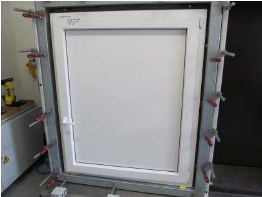
Bild 1 Probekörperansicht auf Prüfstand Fenster geschlossen
